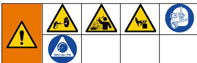
Este equipamento permanece pressurizado até efetuar a descompressão manualmente. Para ajudar a evitar ferimentos graves devido ao líquido pressurizado, como injeção na pele, salpicos de líquido e peças e movimento, siga o Procedimento de descompressão quando parar de pintar e antes de limpar, verificar ou reparar o equipamento.
